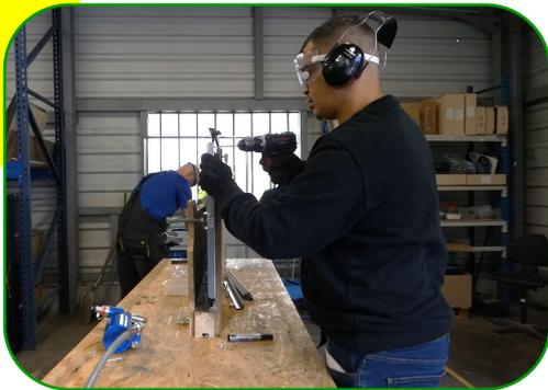
Perçage des planches et des montants avec une perceuse électrique.
