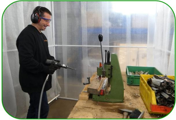
Utilisation d'un burin pneumatique pour enlever les rivets des montants.
